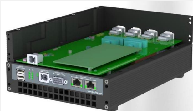
图3: 打开SCB外壳的b-HiL
